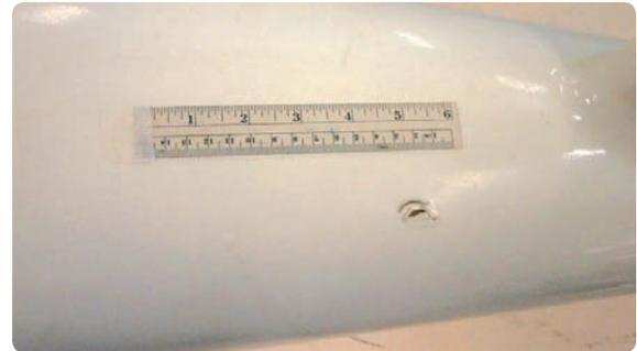
[그림 3-31] Digital image of impact damage
